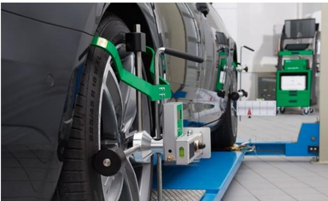
Mit zum Kit gehört eine webbasierte Assistenzsoftware für Achseinstellungen. Diese bietet den Zugriff auf eine Fahrzeugdatenbank mit Sollwerten für Spur und Sturz sowie die Möglichkeit zur Dokumentation der Messergebnisse.
