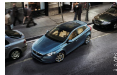
Intelligente Park-Lenk-Assistenten ermitteln via Ultraschall passende Parklücken und übernehmen die Lenkarbeit
