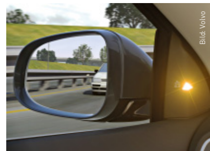
Um vor riskanten Spurwechselmanövern zu warnen, scannen Radarsensoren im Heck den Bereich hinter und neben dem Fahrzeug.
