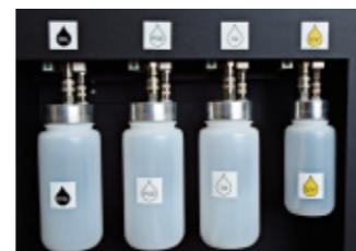
4. Im seitlichen Kompartiment werden Altöl und – in hermetisch abgeschlossenen Behältern – POE- und PAG-Öl sowie UV-Additiv gelagert
