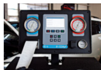
11. Im Ausdruck wie auch im integrierten Speicher dokumentiert der HUSKY die Fahrzeugdaten, Ergebnisse der Analyse und Vakuumprüfung, Rückgewinnungs- und Befüllmengen, Öltyp sowie befülltes UV-Additiv
