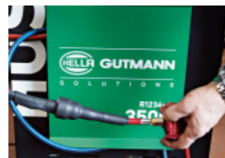
3. Dank eines in der Füllleitung integrierten elektromagnetischen Ventils erzielt der HUSKY 3000/3500 eine überdurchschnittliche Genauigkeit beim Befüllen mit Kältemittel von +/- 7 g
