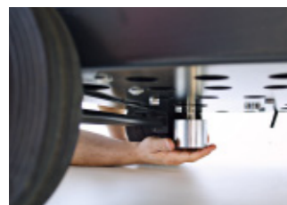
5. Für hochgenaue Befüllungen lassen sich die fünf elektronischen Waagen für die Fluide mit dem mitgelieferten Eichmittel kalibrieren
