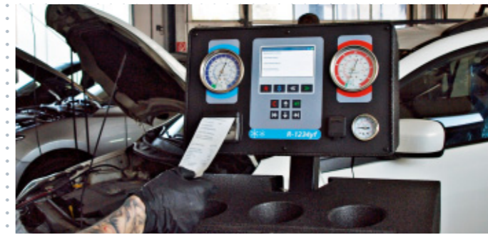
Durch die integrierte Kältemittelanalyse des HUSKY 3500 ist dieses Ergebnis auch gleich im Protokoll integriert.
