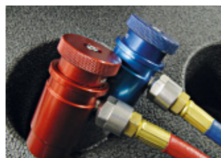
6. Die besonders edlen Kupplungen verfügen über doppelte Dichtflächen und einen Bypass, der einen undichten Ventilkern sofort detektiert
