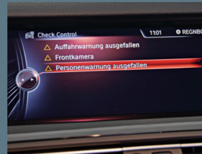
Durch unplausible Daten der Kamera fallen gleich mehrere FAS aus
