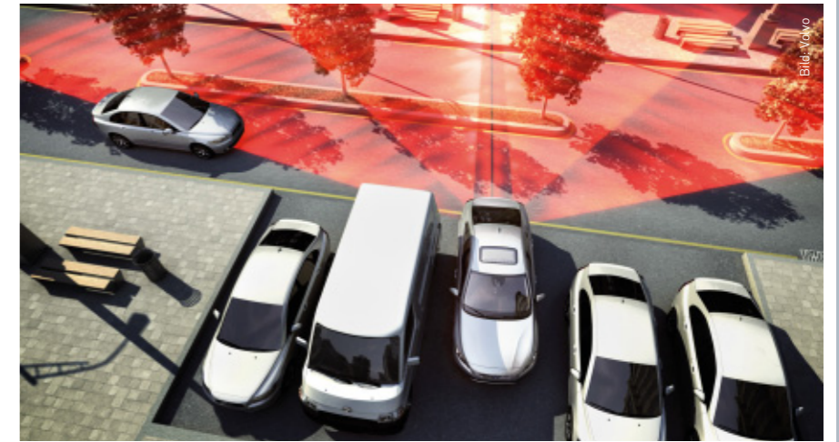
Aktive Parkassistenten erhalten u.a. Informationen von Radarsensoren im hinteren Stossfänger und warnen beim Ausparken vor Querverkehr
