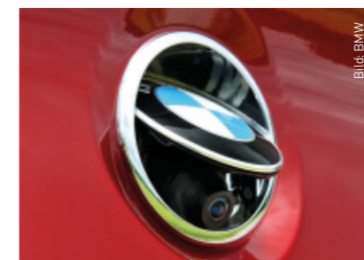
Häufig unentdeckt aber immer häufiger: die Rückfahrkamera
