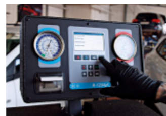
7. Nach der positiven Kältemittelanalyse fordert das Gerät zur Fahrzeugauswahl oder manuellen Füllmengeneingabe und zum Anschliessen der Leitungen auf. Alles Weitere erfolgt vollautomatisch
