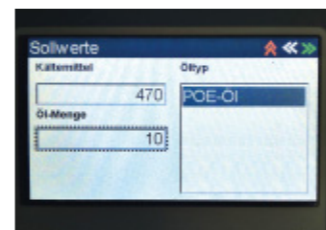
8. Der HUSKY weiss, ob es sich um ein Standard-, Elektro- oder Hybridfahrzeug handelt, und wählt den erforderlichen Modus, um Schmiermittel-Kreuzkontaminationen zu vermeiden. Danach wird die korrekte Öl-Sorte/-Menge und Kältemittelmenge nachgefüllt
