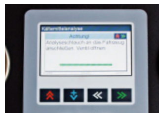
1. Die Kältemittelanalysefunktion ist in den Komplettablauf des HUSKY 3500 integriert und Voraussetzung für den Ablauf
